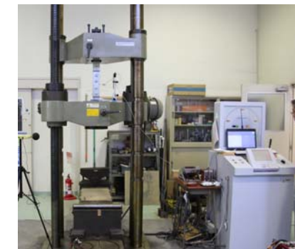
すべり試験状況
